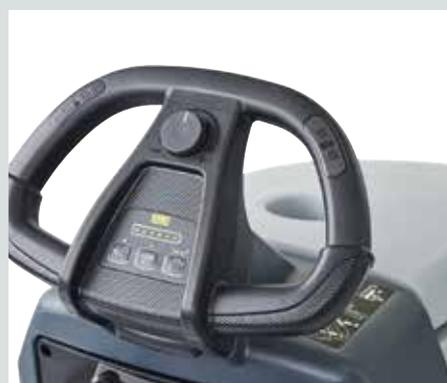
Простой запуск машины обеспечивается эргономичной ручкой с сенсорными датчиками, кнопкой OneTouch™ и информационными наклейками
